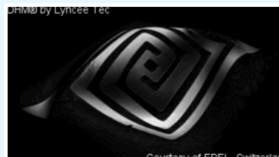
800 °C 下 Micro Hot Plate 的热变形 5× 物镜 (NA 0.12), FOV 1.2 mm × 1.2 mm
